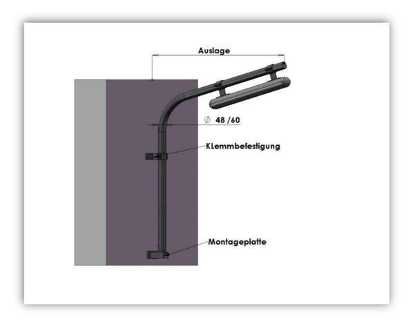
Wandmaste sind in gebogener Ausführung aus Stahlrundrohr mit unterschiedlichen Bauhöhen sowie Auslagen individuell auf Ihre Bedürfnisse abgestimmt erhältlich. Zu jedem Wandausleger werden die passenden Schellenbefestigungen mitgeliefert.
